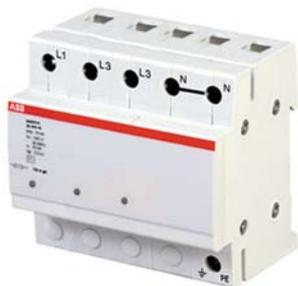
Устройства защиты от импульсных перенапряжений OVR T1+2 созданы на базе разрядника и варистора. Защищают от перенапряжений, вызванных прямым ударом молнии (фронт волны 10/350мкс), удаленным ударом молнии, а также от перенапряжений в сети технологического характера (фронт волны 8/20мкс).
