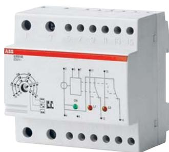
Реле LSS осуществляет постоянный контроль текущей потребляемой мощности и сравнивает ее с максимально допустимым значением. При превышении указанного предела, реле отключает одну или две группы неприоритетных нагрузок (NPL1 и NPL2) чтобы не допустить срабатывания главного автоматического выключателя. Через заданные интервалы времени происходит автоматическое подключение нагрузок.
