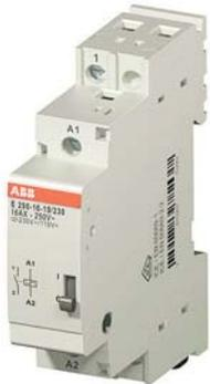
Электромеханические блокировочные реле E290 замыкают и размыкают свои контакты при каждом импульсе, посланном на катушку управления посредством кнопки с НО контактом. Эти реле используются для управления освещением, как из одной, так и из нескольких точек. Имеются различные исполнения в зависимости от питающего напряжения и количества контактов. Реле E290 могут объединяться с модулями силовых и вспомогательных контактов, а также модулями управления.
