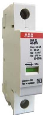
Устройства защиты от импульсных перенапряжений OVR T2 созданы на базе варистора и защищают от перенапряжений, вызванных удаленным ударом молнии, а также перенапряжений в сети технологического характера (фронт волны 8/20мкс).
