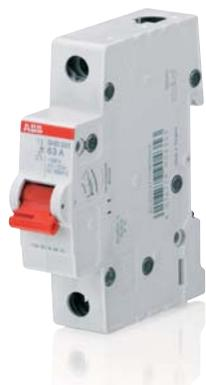
Выключатели нагрузки SHD200 серии Compact Home повторяют профиль автоматических выключателей SH200L, соединяются стандартными шинными разводками. В гражданском строительстве часто используются для коммутации разветвленных и уже защищенных цепей для исключения возможности отключения нескольких нагрузок при коротком замыкании. Номинальный ток от 16 А до 63 А. Соответствие ГОСТ Р 50030.3-99
