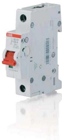
Выключатели нагрузки SD 200 серии System pro M compact повторяют профиль автоматических выключателей S200. Среди преимуществ серии SD200 надо отметить двойные цилиндрические клеммы, наличие индикатора состояния контактов и полную совместимость с аксессуарами для автоматических выключателей S200. Номинальный ток от 16 А до 63 А. Соответствие ГОСТ Р 50030.3-99
