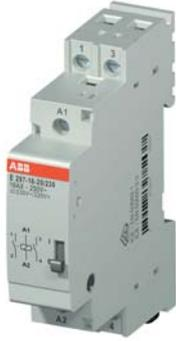
Реле E297 представляют собой контакторы на 16 А и предназначены для управления освещением в жилом и коммерческом секторе. Оснащены ручным приводом (без фиксации). Реле E297 могут объединяться с модулями силовых и вспомогательных контактов.
