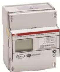
Счетчики DELTAsingle прямого включения на максимальный ток до 80 А предназначены для учета электроэнергии в однофазной сети в двух и четырехтарифном режиме. Многотарифные модели имеют встроенный тарификатор для управления тарифами. Зарегистрированы в Госреестре средств измерений РФ под №44623-10. Включены в перечень приборов учета энергии, рекомендованных ОАО «Мосэнергосбыт».
