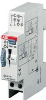
Реле E232 управляются с помощью кнопочных выключателей с индикаторными лампами и имеют настраиваемую выдержку по времени. Данные реле применяются для управления освещением необслуживаемых помещений: лестничных клеток, гаражей, автостоянок, а также могут использоваться для включения оборудования на непродолжительное время.
